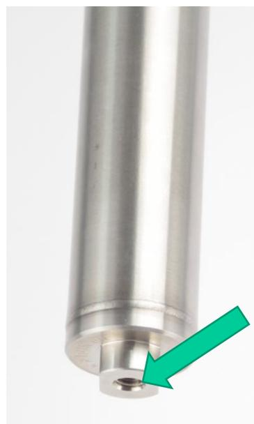
Wenn das Schüttgut zu leicht sein sollte, um den Neigungsschalter zu verdrängen, kann an ihm nachträglich ein bauseitiger Auftriebskörper oder Flügel angeschraubt werden. Ein M10-Gewinde an der Unterseite des Gehäuses ist hierfür bereits vorhanden.
